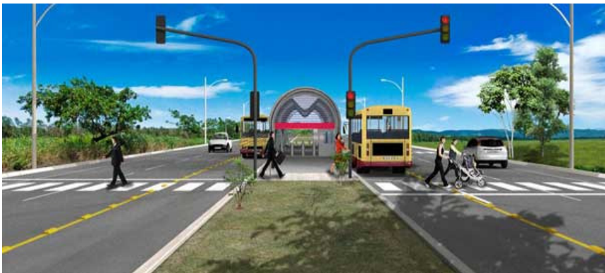
A mesma observação pode ser efetivada nesta foto frontal onde uma faixa de pedestres interfere em meio a via de circulação de ônibus de alta velocidade. (foto: www.piniweb.com.br )
